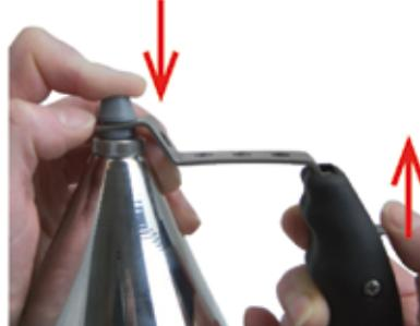
2. Die Düse nach unten drücken und mit dem Feststellhebel durch Drücken nach oben verriegeln.
