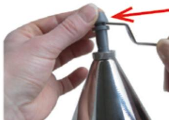
1. Den Bügel in die Düsenkerbe einsetzen.
