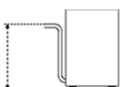
**IN DIESEM FALL BETRÄGT DIE MAXIMAL ZULÄSSIGE HÖHE DES ABFLUSSES 1 METER. STETS PRÜFEN, DASS DER ABFLUSS RICHTIG FUNKTIONIERT UND NICHT VERSTOPFT IST.**
