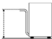
**DANS CE CAS, L'ÉVACUATION DOIT SE SITUER À UNE HAUTEUR MAXIMALE DE 1 MÈTRE. IL FAUT TOUJOURS VÉRIFIER QUE L'ÉVACUATION NE SOIT PAS OBSTRUÉE ET/OU ENTARTRÉE.**
