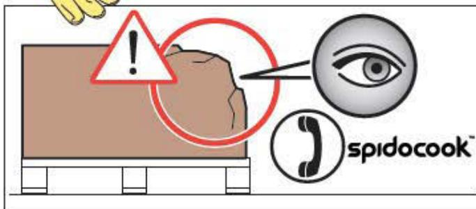
Stellen Sie sicher, dass das Gerät während des Transports nicht umkippen kann. Beim Erhalten die Verpackung kontrollieren, dass keine sichtbaren Schäden vorhanden sind. Wenn dem nicht der Fall ist, umgehend Spidocook S.r.l. informieren und NICHT mit der Montage beginnen.
