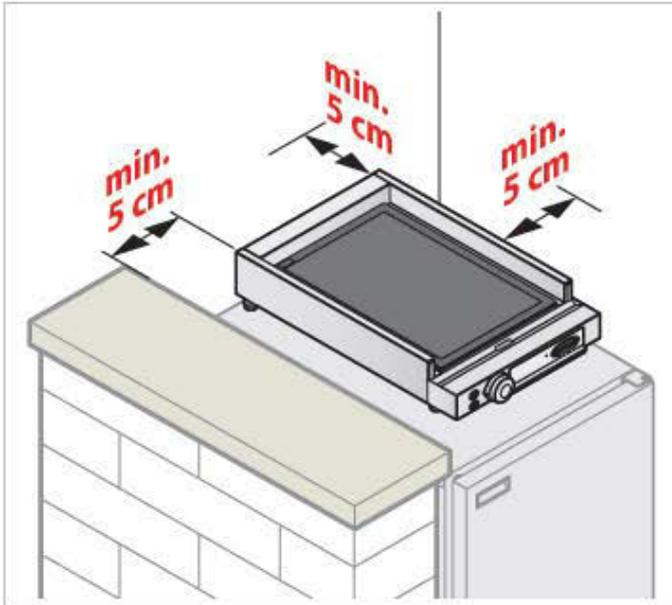
Positionieren Sie das Gerät unter Beachtung der Abstände, die in der Abbildung angegeben werden. Die hintere Wand muss leicht erreichbar sein, um die Anschlüsse zu erleichtern und um die Wartung zu ermöglichen.
