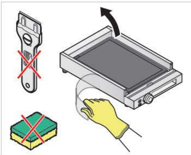
Entfernen Sie die Schutzfolien vom Gerät. Eventuelle Klebstoffrückstände mit geeignetem Lösemittel entfernen, ohne die Oberfläche mit Werkzeugen oder aggressiven oder ätzenden Reinigungsmitteln zu beschädigen.
