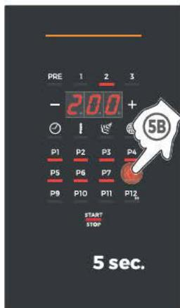
En choisissant une position différente, par exemple P8, le programme P7 conserve les paramètres d'origine (donc la température à 180 °C) tandis que le programme P8 aura les mêmes paramètres que P7 sauf la température qui sera de 200 °C.
