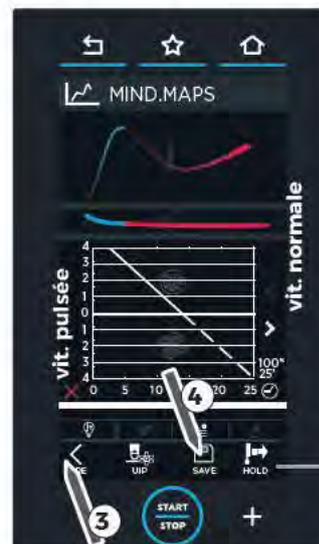
HOLD : permet le fonctionnement du four en mode continu
