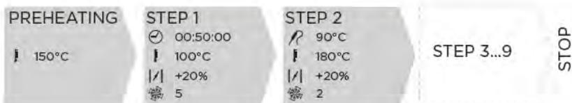
exemple de programmation des paramètres (STEP de 3 à 9 non utilisés)
