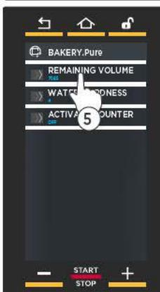
Sélectionnez le paramètre «volume restant» : sur l'écran apparaîtront les litres résiduels qui manquent avant de devoir remplacer le filtre.
