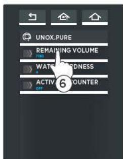
Sélectionnez le paramètre «volume restant» : sur l'écran apparaîtront les litres résiduels qui manquent avant de devoir remplacer le filtre.
