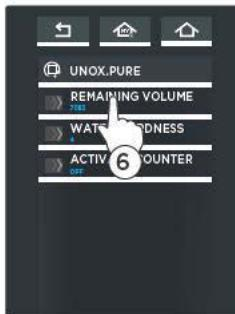
Den Parameter „Restkapazität“: Auf dem Display wird angezeigt, wie viele Liter Wasser nach dem Filterwechsel noch vorhanden sind.
